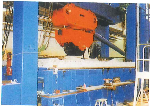
旧建設省土木研究所(財)土木研究センター、民間15社による共同研究「道路橋床版の輪荷重走行試験機における疲労耐久性評価手法の開発」(平成11年10月)より
